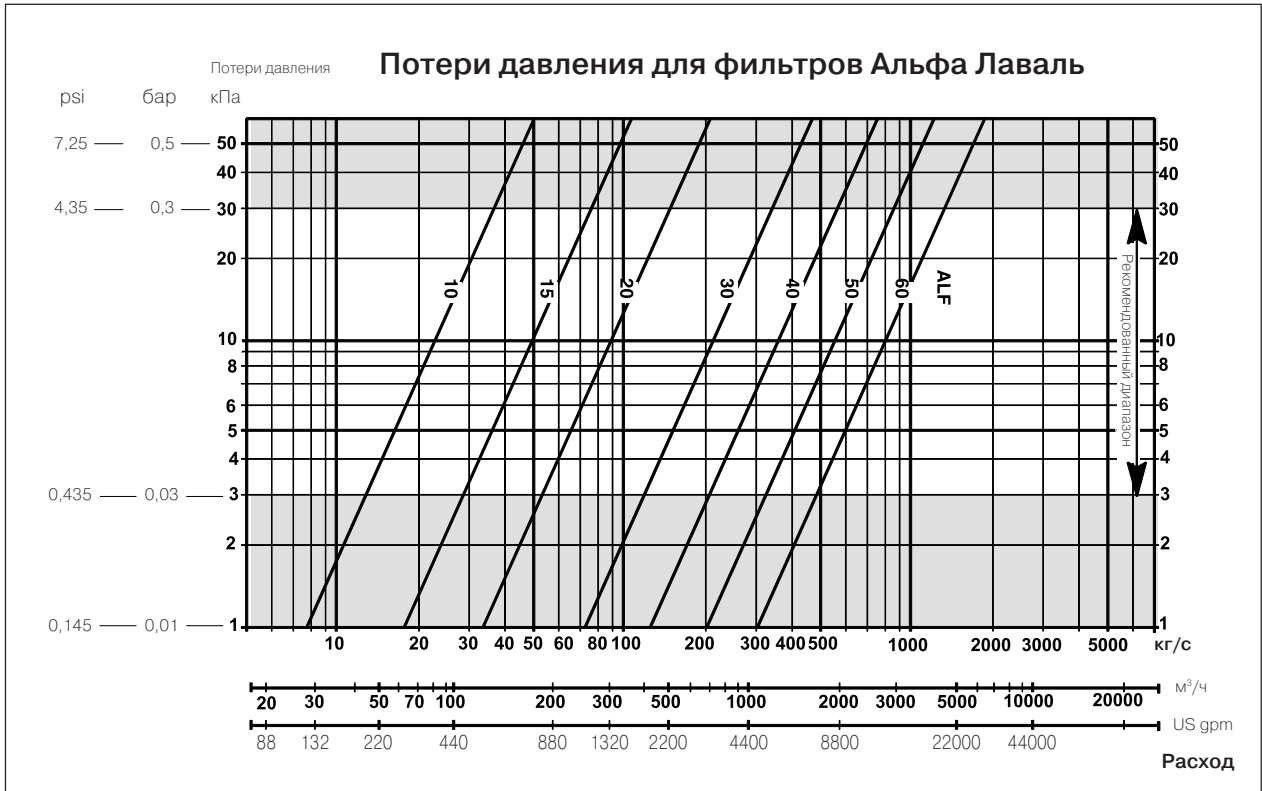
Рис. 3. Диаграмма зависимости потери давления от расхода прокачиваемой жидкости
