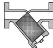
Если в какой-либо среде присутствуют частицы более 1 мм, рекомендуем установить перед обменником сетчатый фильтр с размером отверстий 1,5 мм. В противном случае эти частицы могут заблокировать каналы, что приведет плохой работе, увеличит перепад давлений и риск замораживания.
