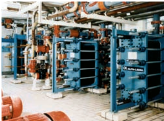
Пластинчатые теплообменники DIABON® Альфа Лаваль с пластинами из материала F100, используемые для охлаждения слабой серной кислоты в ртутной восстановительной секции технологической установки на финском цинковом заводе
