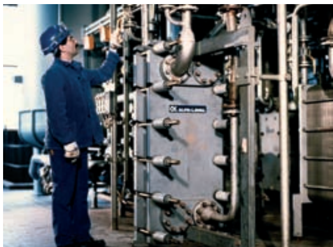
Пластинчатые теплообменники DIABON® Альфа Лаваль с пластинами из материала NS1, используемые для охлаждения соляной кислоты на одном из немецких заводов.
