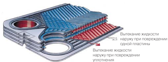
Рис. 5. Схема пар пластин с двойными стенками, сваренных по периметру отверстий
